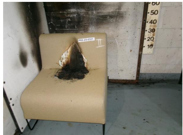
Abb.4: Sitz 2 nach der Prüfung Fig.4: Seat 2 after testing
